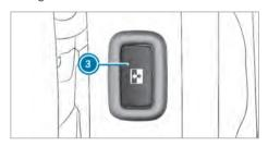
Sliding door button on the door sill (B-pillar)
