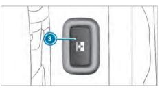
Sliding door button on the door sill (B-pillar)
