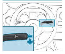
Натисніть кнопку ①. Індикація положення коробки передач на багатофункціональному дисплеї вказує на Р.
