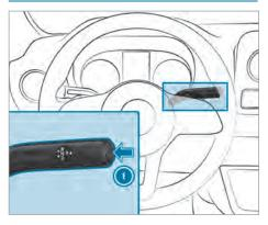
► Натисніть кнопку ①. Індикація положення коробки передач на багатофункціональному дисплеї вказує на ГР.
